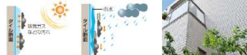
太陽の光で汚れを浮かせ、雨が降ると洗い落ちる光触媒タイル。
